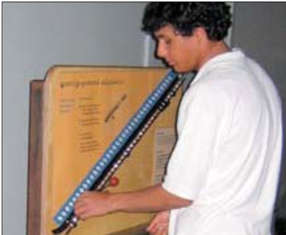
هذه الأداة غريبة الشكل تقيس في الواقع الجذور التربيعية.
